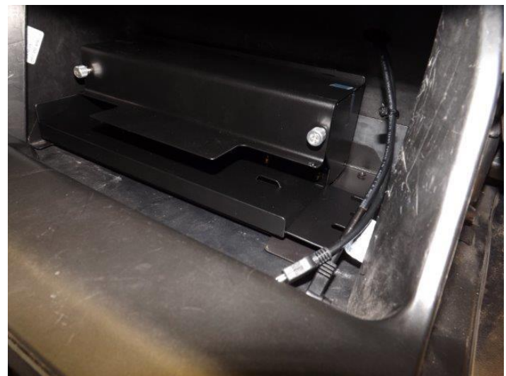
הנחת חלק התקנה מקורי על חלק התקנה המקובע בתא כפפות
